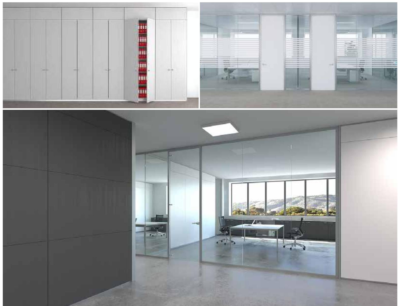
Ufficio è razionalizzazione degli spazi con parete divisoria e parete monovetro. La parete divisoria è costituita da strutture in acciaio zincato rivestite con guarnizioni in PVC; canale inferiore, finiture verticali, stipiti e telai vetrati in alluminio lega 6060 anodizzato colore naturale e pannelli in truciolare nobilitato melaminico sp. 18 mm bordato con PVC 10/10 raggiato.
